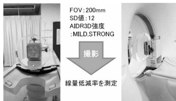
図5 水ファントムでの線量低減率測定
